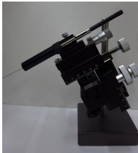
圖九 固相微萃取法(SPME)搭配顯微注射器(Micro-injector)
