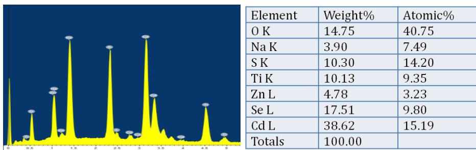
圖5  $\text{TiO}_2/(\text{CdZnS})_4/(\text{CdZnSe})_2$  EDS分析
