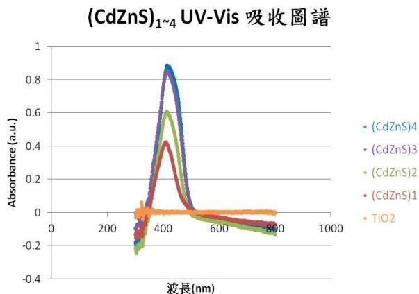
圖 7  $\text{TiO}_2/\text{(CdZnS)}_{1\sim 4}$  UV-Vis 吸收圖譜
