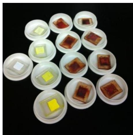
圖1 不同量子點光電極外觀
