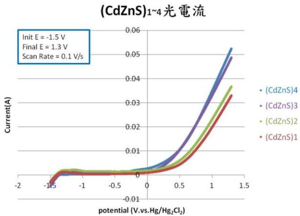
圖10 TiO<sub>2</sub>/(CdZnS)<sub>1~4</sub> 電壓電流圖
