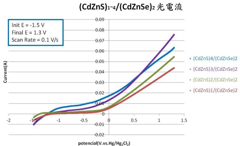
圖 11  $\text{TiO}_2/(\text{CdZnS})_{1\sim 4}/(\text{CdZnSe})_2$  電壓電流圖
