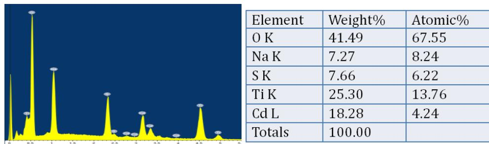
圖4  $\text{TiO}_2/(\text{CdZnS})_4$  之EDS分析
