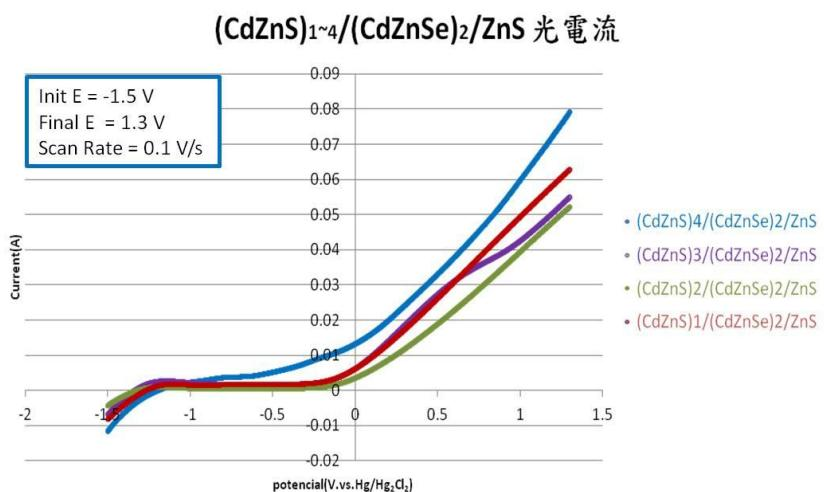
圖 12  $\text{TiO}_2/(\text{CdZnS})_{1\sim 4}/(\text{CdZnSe})_2/\text{ZnS}$  電壓電流圖
