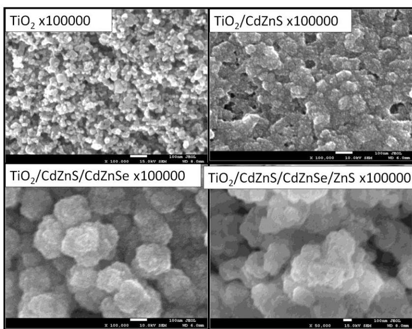
圖2 不同量子點在 SEM 下的團狀結構
