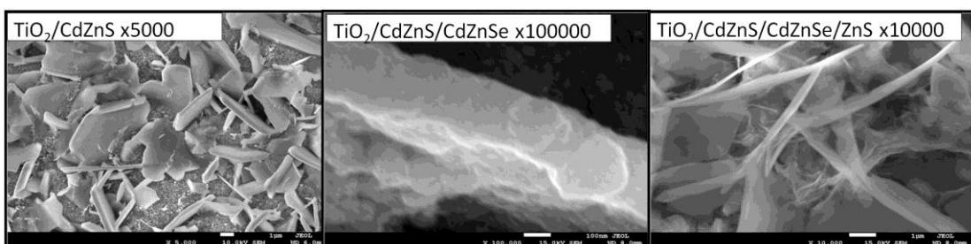
圖3 不同量子點在 SEM 下的綵帶狀結構
