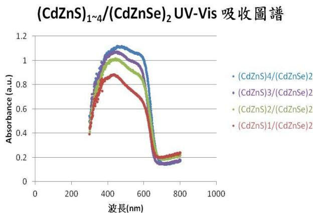
圖 8  $\text{TiO}_2/\text{(CdZnS)}_{1\sim 4}/(\text{CdZnSe})_2$  UV-Vis 吸收圖譜
