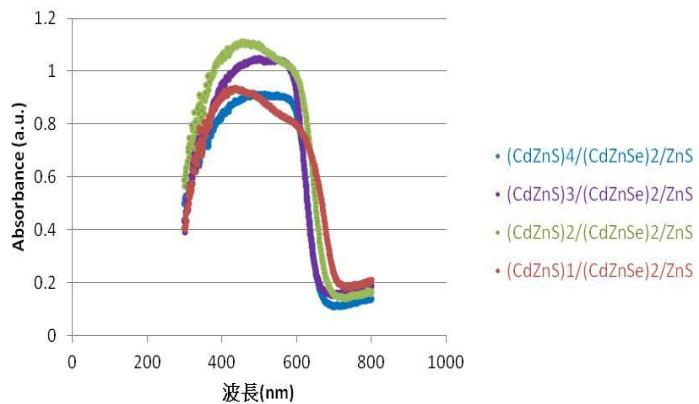
圖9 TiO<sub>2</sub>/(CdZnS)<sub>1~4</sub>/(CdZnSe)<sub>2</sub>/ZnS UV-Vis吸收圖譜
