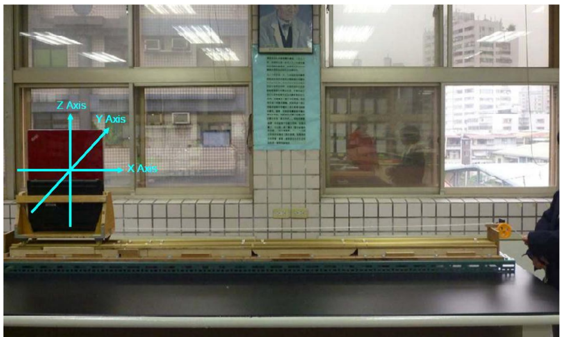
圖十二、以繩索拉動台車，記錄加速度感測器在落下時的加速度值
