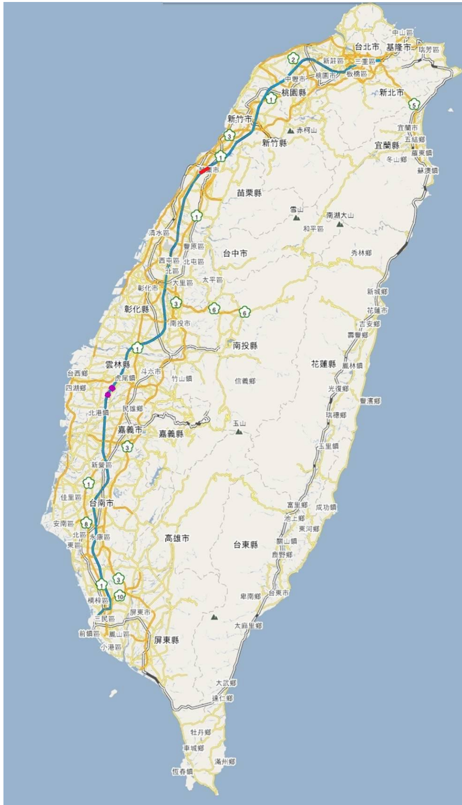
圖十八、台灣高速鐵路全線差異沉陷線分布圖(藍色表示高鐵全線、紅色表示差異沉陷仍在、紫色表示已改善)
