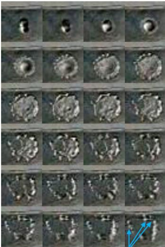
圖七-(11)：水滴在撞擊 400°C 金屬面之後的擴張情形。水珠最後形成數顆小水滴而沒有縮合回去，如圖箭頭處。
