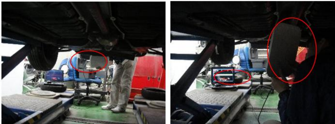
圖 6.4 天線分別由前保險桿下及車底盤正中央讀取 RFID 標籤
