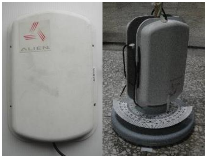
圖 2.6 RFID 915 MHz 圓極/線極天線
