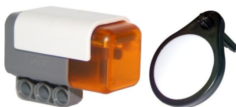
圖 2.4 低頻 RFID 讀取器及識別標籤 (CODATEX, 2011)
