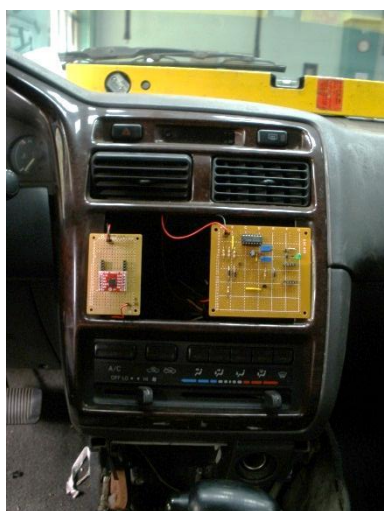
圖四十一:電路板由汽車電瓶供電
