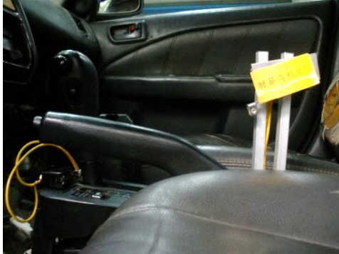
圖四十五:手煞車高點開關安裝
