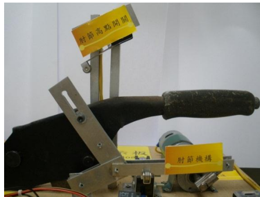
圖三十五:肘節機構自動回復初始位置
