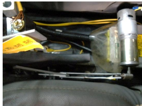
圖四十八:肘節機構不作動
