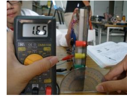
圖十一:加速規尚未傾斜電壓值
