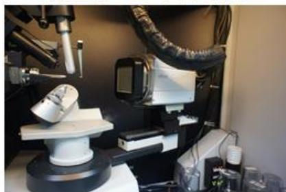
CCD 單晶 X 光繞射儀
