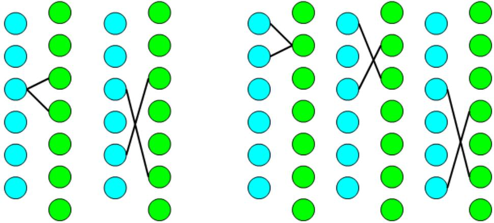
每一個特徵圖格子所產生的關係線都類似上圖的 X 狀，而左側開口較小的 X 是由狹義特徵圖格子所產生的(左兩張圖)，右側開口較小的 X 是由廣義特徵圖格子所產生的(右三張圖)。
