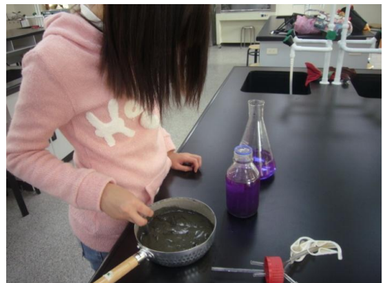
圖 13. 將污泥置於培養基中
