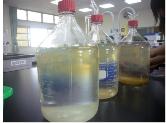
圖 11. 蔗糖基質倒入 5 公升的基質瓶內
