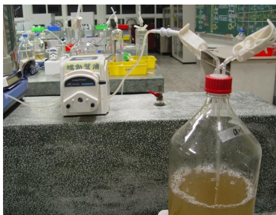
圖 22. 利用蠕動幫浦將基質送入發酵反應圖
