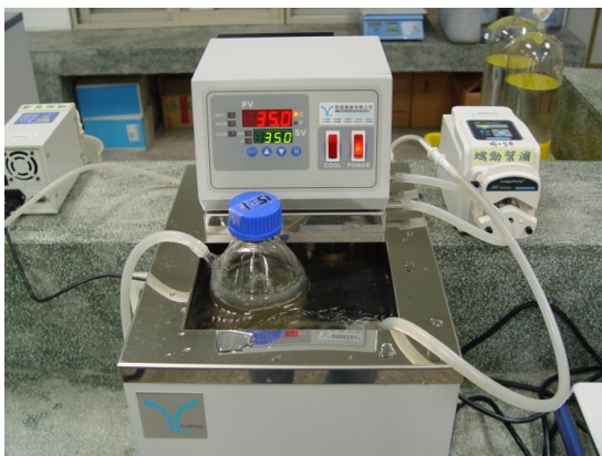
圖 16. 將產氫厭氧發酵槽定溫 35°C
