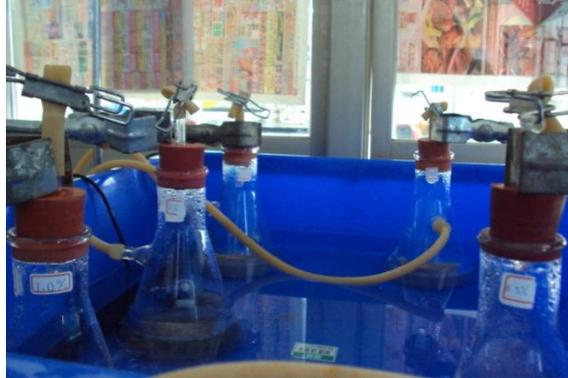
b、恆溫槽水溫控制 35°C，反應前檢測基質的醱度。
