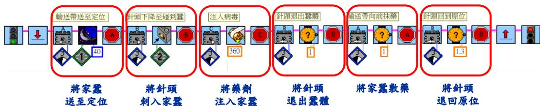
圖 2F.2 家蠶自動注射系統之 Robolab 控制程式
