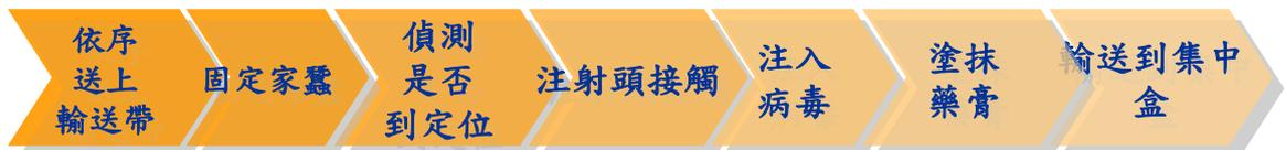
圖 2F.1 家蠶自動注射系統之控制流程
