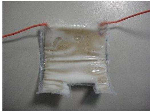
圖 3B.6 電流變液 U 型液袋
