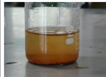
C 廢水加入黃血 鹽水溶液後 2\text{Cu}^{2+} + \text{Fe}(\text{CN})_6^{4-} \rightarrow \text{Cu}_2\text{Fe}(\text{CN})_6 紅棕色
