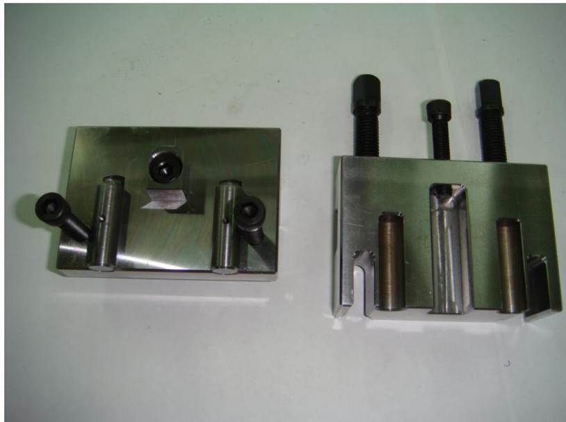
第三代車刀架(左-固定本體、右-刀架)
