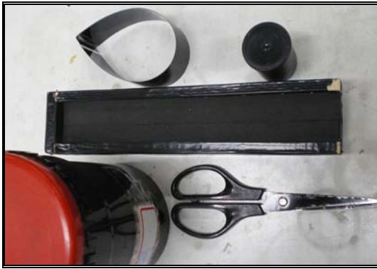
圖(25)：暗箱中放置沖洗罐、剪刀、軟片盒、軟片量尺、塑膠套環。
