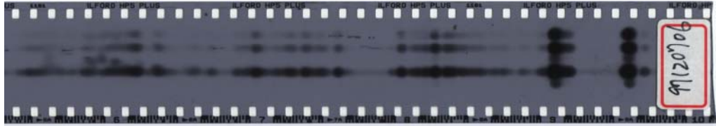
圖(18)：操作安裝與拆卸軟片時的轉動，外界光從光纖進來的混亂顯影。
