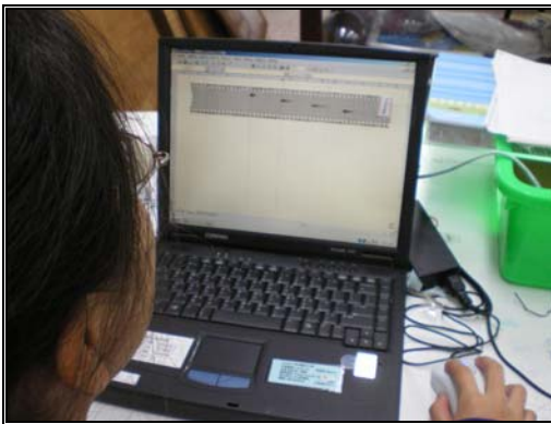
圖(31)：透明膠帶將軟片貼在螢幕上。 圖(32)：用欄位寬度量測顯影間距。
