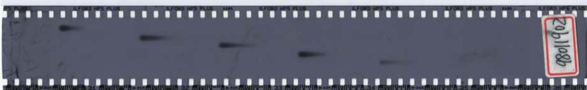
圖(b)：預混氣 ( 2\text{H}_2 + \text{O}_2 ) + \text{H}_2 ，RPM=25055，軟片 ISO 400。
