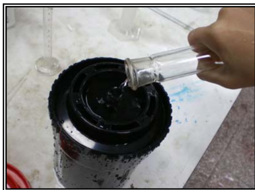
圖(29)：藥水倒入沖洗罐。
