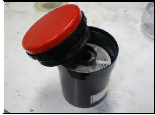
圖(28)：暗箱中鎖緊蓋子，防止曝光。
