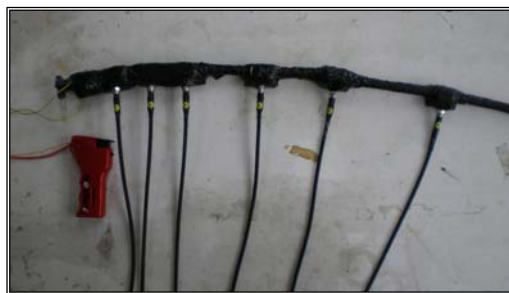
圖(35)：6 個偵測點距離點火處依序為 5、10、15、25、35、50 cm。
