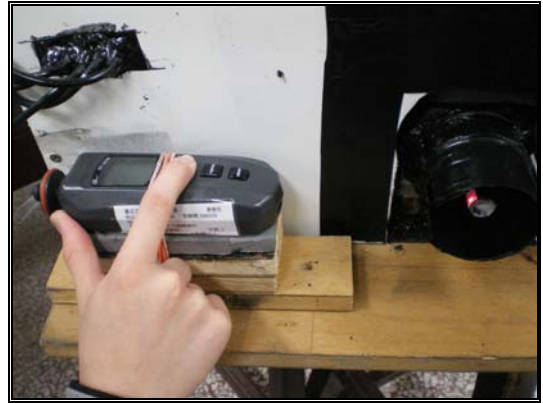
圖(13)：光電轉速計偵測馬達轉速。
