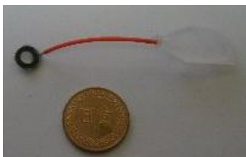
圖 8.4 環片式液體透鏡內視鏡
