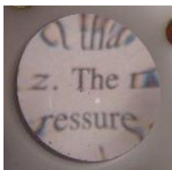
圖 5.1 高倍率下，液體透鏡外緣成像模糊
