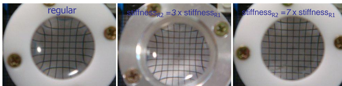
圖 6.6 一般透鏡與低像差透鏡之網格觀察結果
