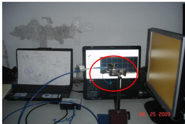
圖八：以光譜儀測量並校正螢幕
