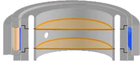
圖 6.6 滾輪移動壓縮囊袋
