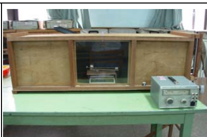
圖二：風洞中測量升力裝置
