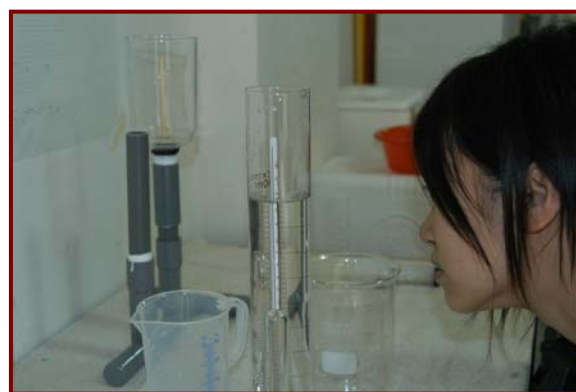
照片 12：測量溶液的比重。
