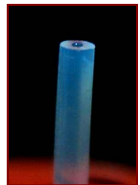
照片 8：鐵氟龍管口的水只在開口處凸起來，不會沾到管口的鐵氟龍牆面上。此時 A 端玻璃漏斗內的水位已經比這個管口高。
