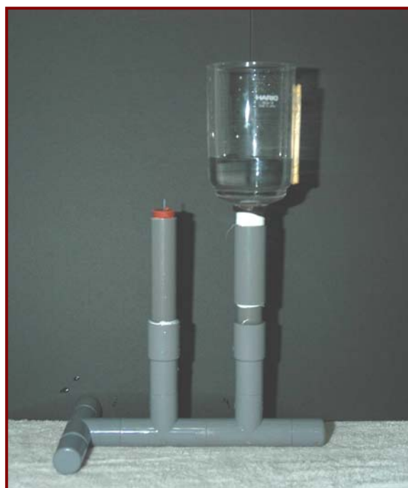
照片 2：測量連通管 A、B 兩端液面高度差；A 端接上煮咖啡器的直筒玻璃漏斗，B 端接一細管。
