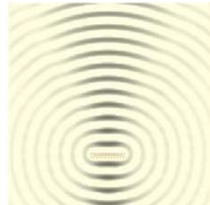
高頻超聲波，波長遠短於聲源直徑，聲場具有強烈指向性。
