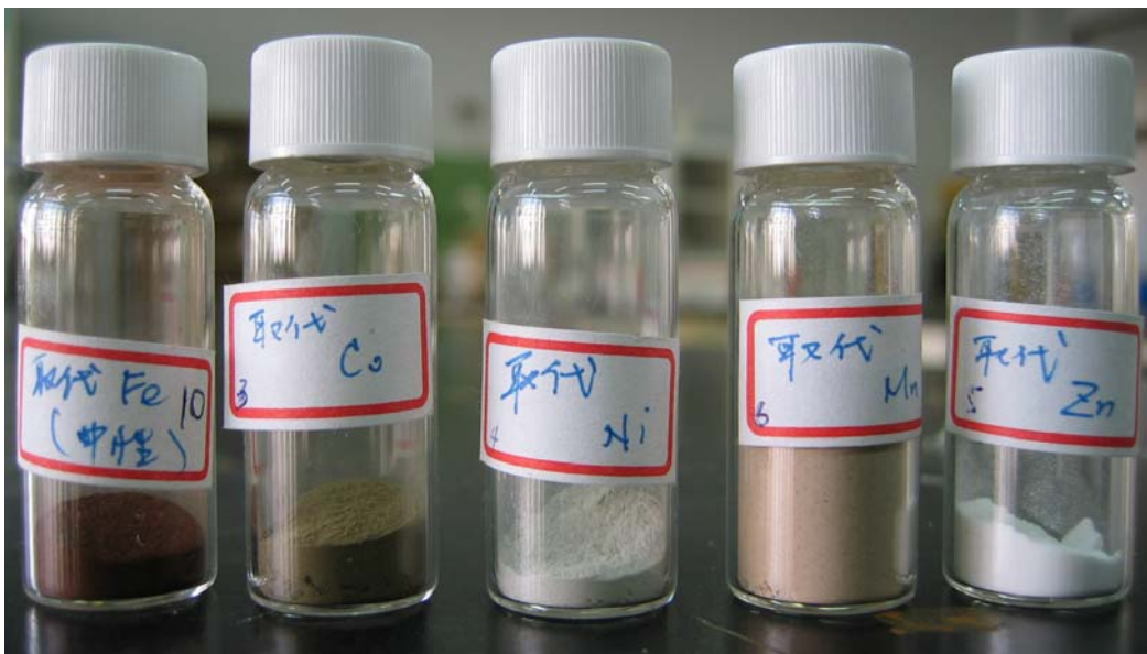
照片四：低矽分子篩浸泡各種金屬鹽溶液離子交換燒結後的粉末
