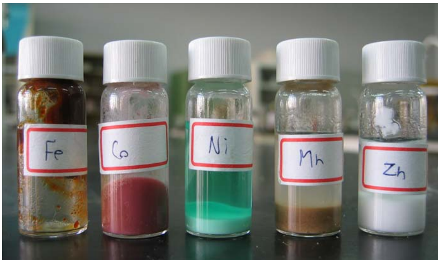
照片三：低矽分子篩浸泡各種金屬鹽溶液
