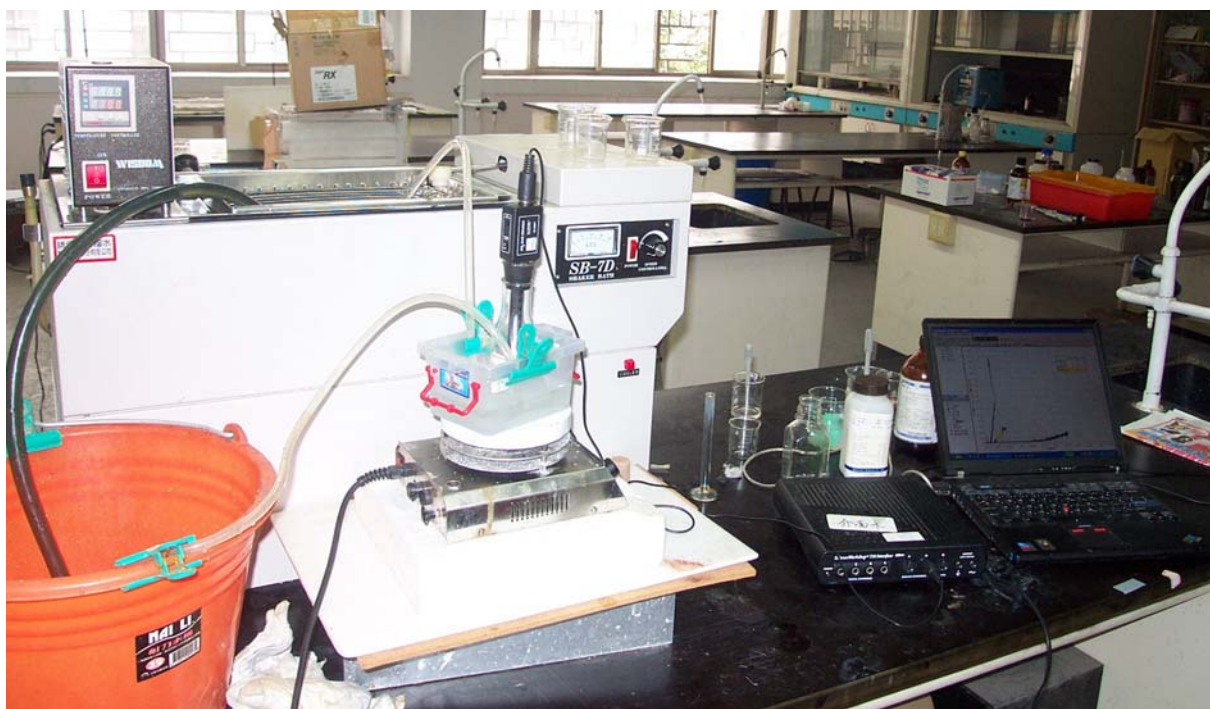
照片一：有機物分解檢測系統架設圖
