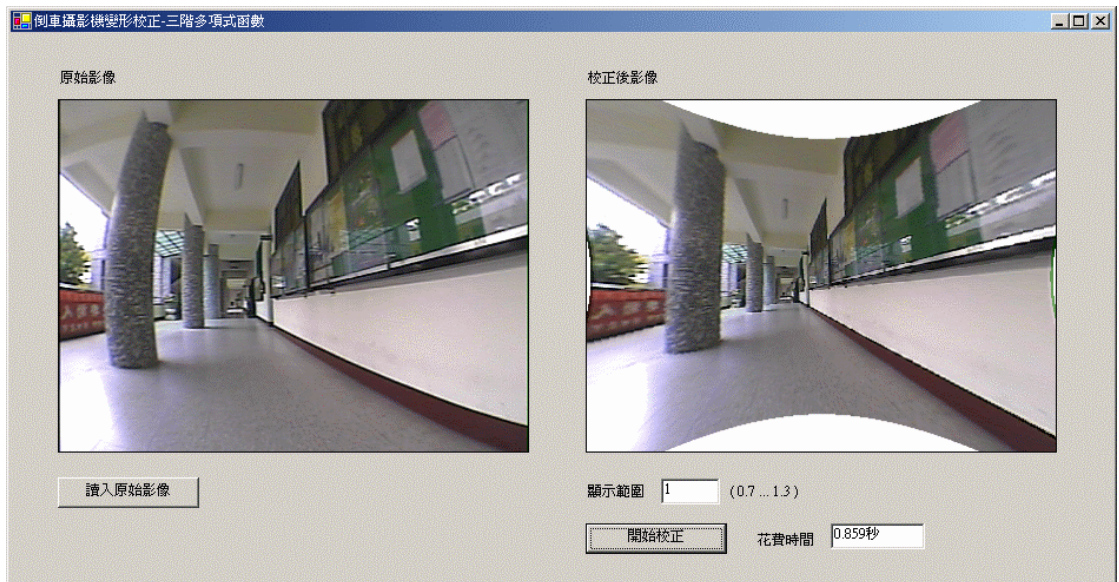
圖 13-1 利用三階多項式函數校正單張倒車攝影機變形影像
