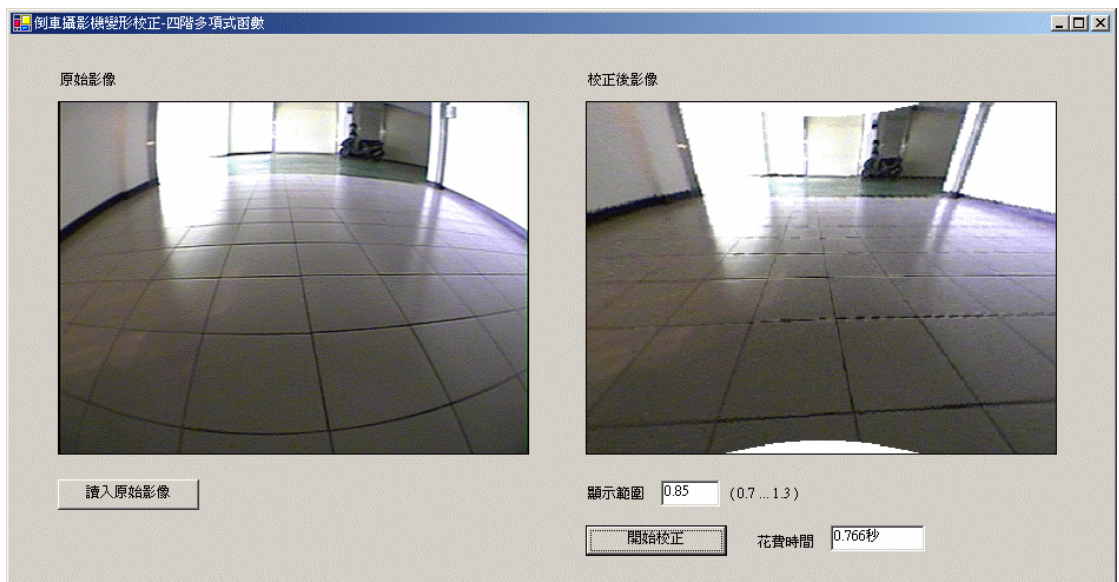
圖 13-2 利用四階多項式函數校正單張倒車攝影機變形影像
