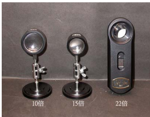
圖 8-1 不同倍率之短焦凸透鏡
