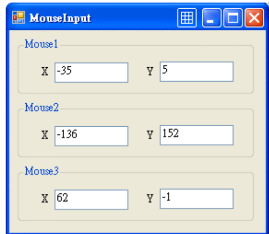
圖 11 以 Raw Input 模式讀取各滑鼠的資料
