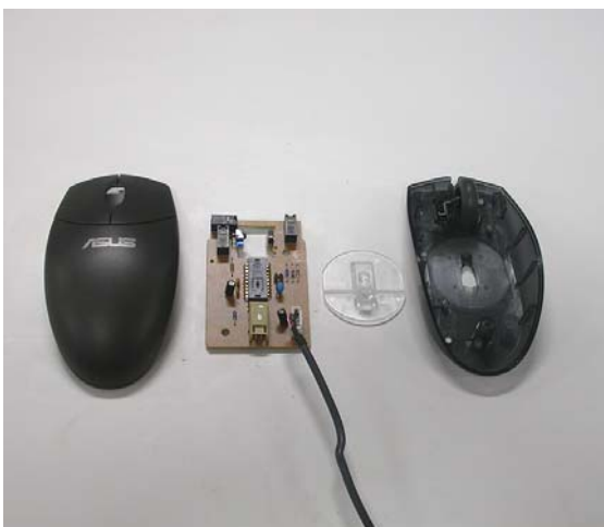
圖 1-3 光學滑鼠的組成元件拆解
