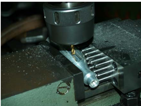
配合油壓虎鉗夾持不規則工件加工
