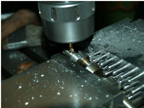
配合油壓虎鉗夾持不規則工件加工
