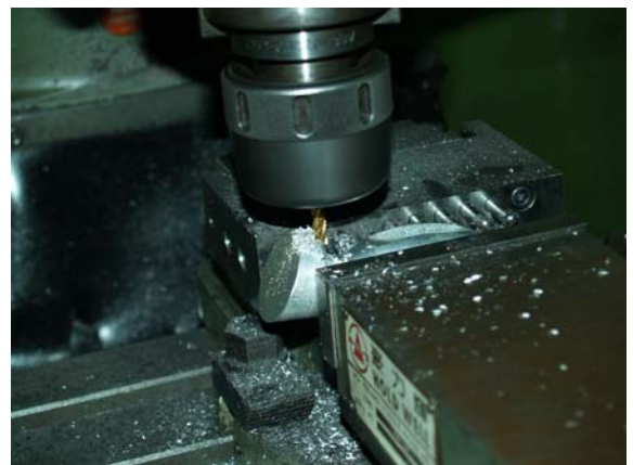
配合油壓虎鉗夾持不規則工件加工
