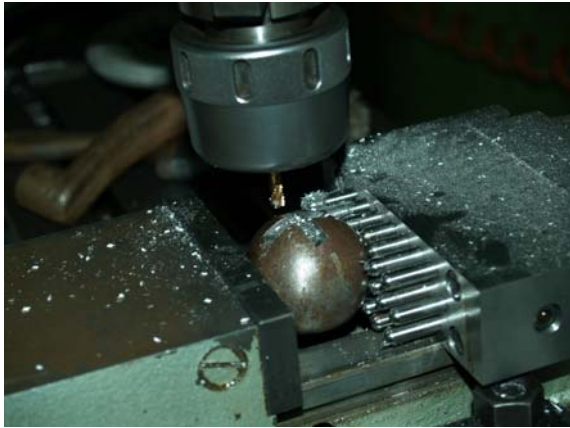
配合油壓虎鉗夾持不規則工件加工
