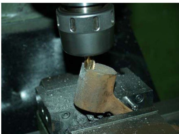
配合油壓虎鉗夾持不規則工件加工
