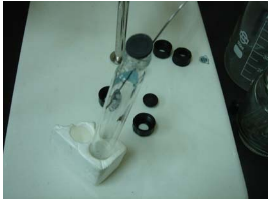
圖八：PYG tube 充氮氣 15 分鐘。
