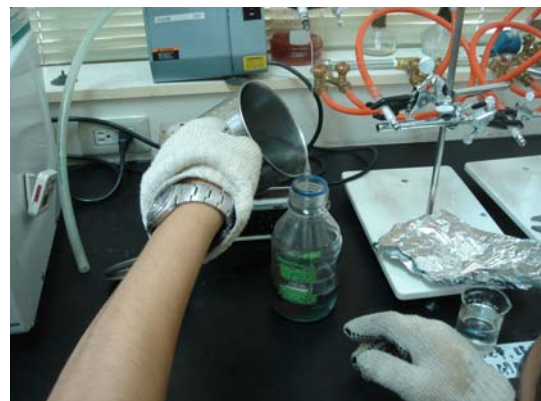
圖五：將沸水加入血清瓶。
