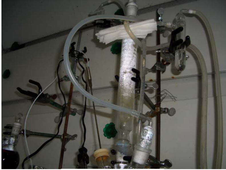
照片四：迴流裝置局部
