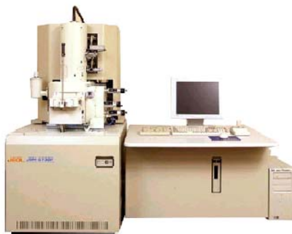
圖 7 SEM 的實際照片 (JEOL JSM-6700F)
