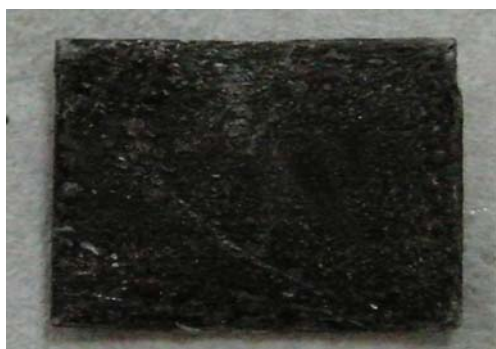
圖2-2-A、純鋅片+H 2 SO 4 反應後的情形
