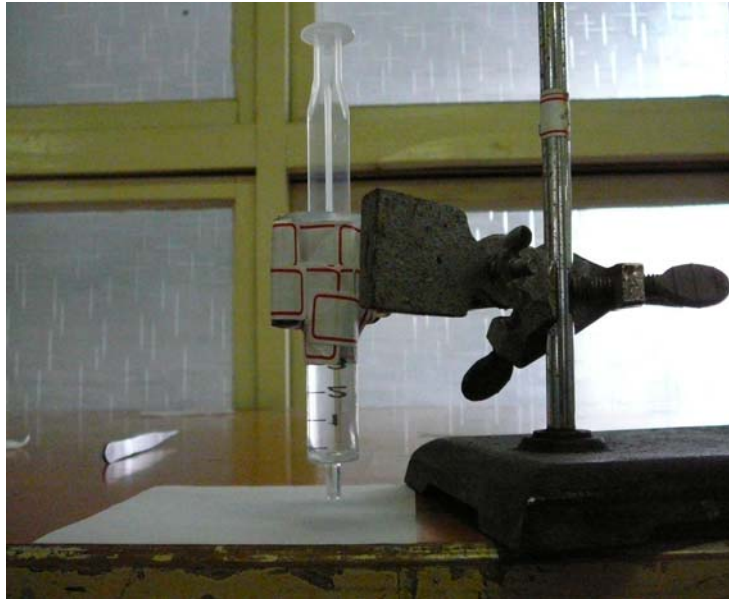
圖：接觸角測定的滴定裝置
