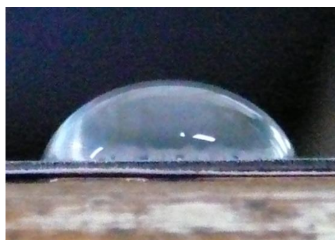
圖5-1-D、操作震盪之SAMs鐵片之接觸角
