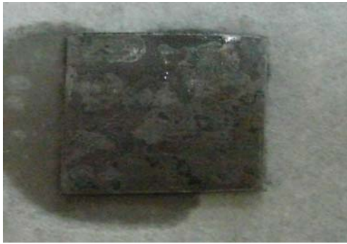
圖6-2-D、SAMs濃度4/11的鐵片 +H 2 SO 4 反應後的情形
