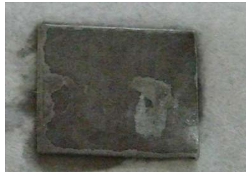
圖6-2-D、SAMs濃度3/12的鐵片+H 2 SO 4 反應後的情形
