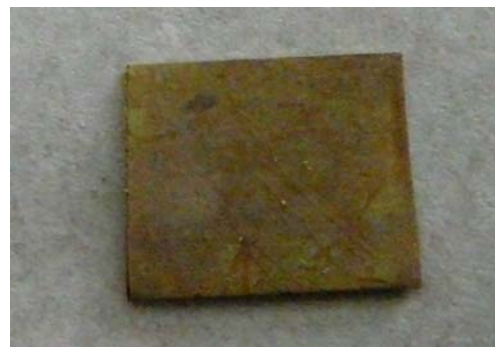
圖2-4-B、經SAMs處理的銅片+HNO 3 反應後之情形
