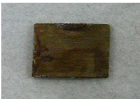
圖2-1-C、只泡酒精之鐵片 +H 2 SO 4 反應後的情形
