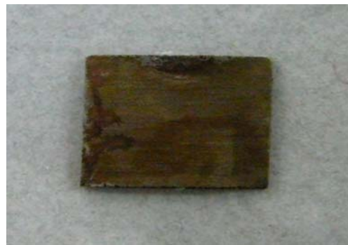
圖6-2-C、SAMs濃度0/15的鐵片+H 2 SO 4 反應後的情形
