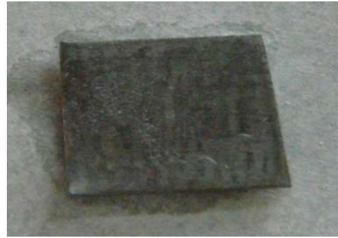
圖6-2-E、SAMs濃度5/10的鐵片 +H 2 SO 4 反應後的情形
