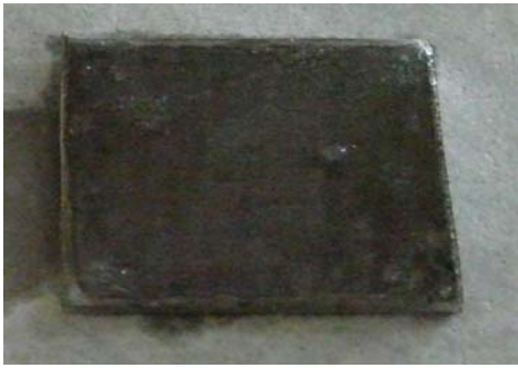
圖5-2-C、在45°C下結合之SAMs的鐵片 +H 2 SO 4 反應後的情形
