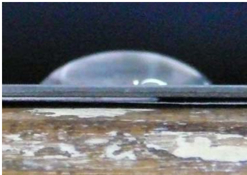
圖3-1-E、160°C下的純鐵片之接觸角
