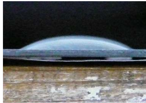
圖6-1-B、SAMs濃度0/15的鐵片之接觸角
