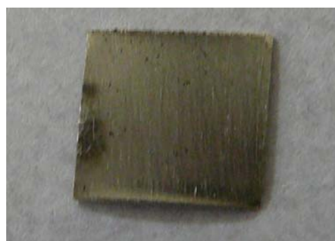
圖2-3-B、經SAMs處理的鎳片 +H 2 SO 4 反應後的情形
