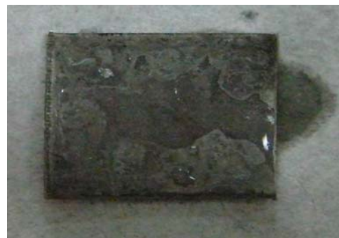
圖5-2-B、在35°C下結合之SAMs的鐵片 +H 2 SO 4 反應後的情形
