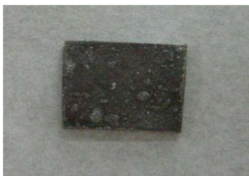
圖2-1-A、鐵片+H 2 SO 4 反應後的情形
