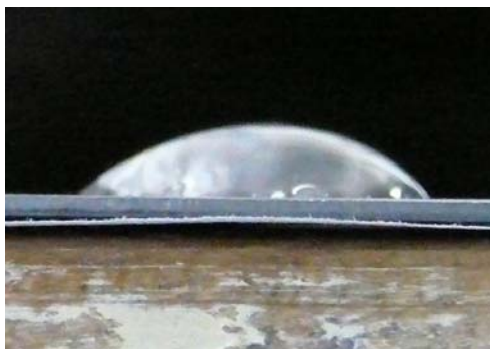
圖3-1-A、25°C下的純鐵片之接觸角
