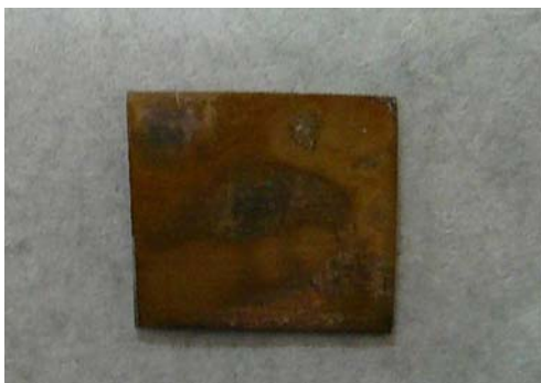
圖2-4-A、純銅片+HNO 3 反應後的情形
