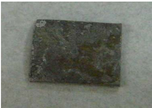
圖6-2-C、SAMs濃度2/13的鐵片+H 2 SO 4 反應後的情形
