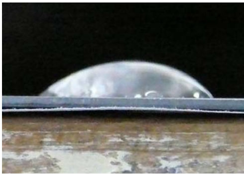
圖6-1-A、純鐵片之接觸角
