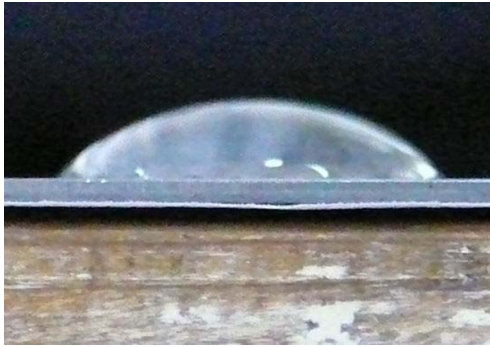
圖3-1-C、80°C下的純鐵片之接觸角
