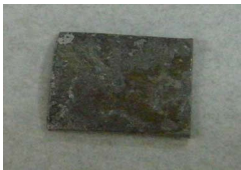
圖5-2-A、在25°C下結合之SAMs的鐵片 +H 2 SO 4 反應後的情形
