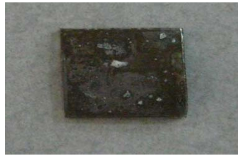
圖5-2-D、在震盪效果下結合之SAMs的鐵片 +H 2 SO 4 反應後的情形
