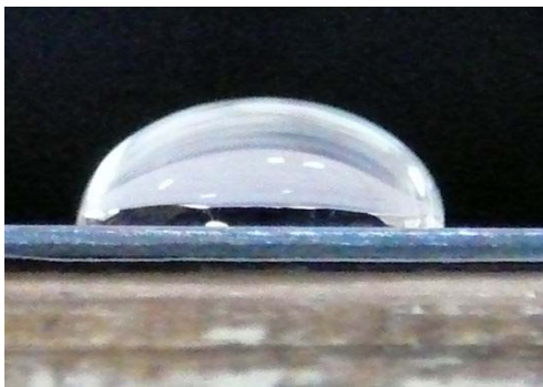
圖6-1-C、SAMs濃度2/13的鐵片之接觸角
