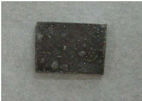
圖6-2-A、純鐵片+H 2 SO 4 反應後的情形
