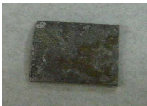
圖2-1-B、經SAMs處理的鐵片 +H 2 SO 4 反應後的情形
