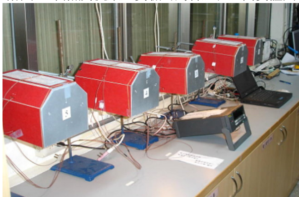
附圖三 自然對流桌燈燈內溫度量測（一小時）
