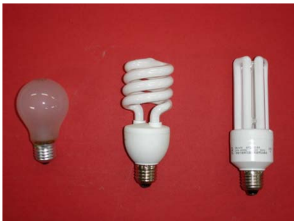
圖十七 實驗用各種燈泡實體圖(由左至右分別是鎢絲燈、螺旋與 3U 燈泡)
