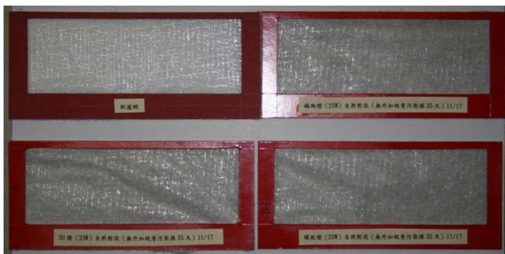
圖五十六 35 天自然對流桌燈濾網 (正面: 由左上角順時針依序為新濾網、鎢絲燈、3U 及螺旋燈濾網)
