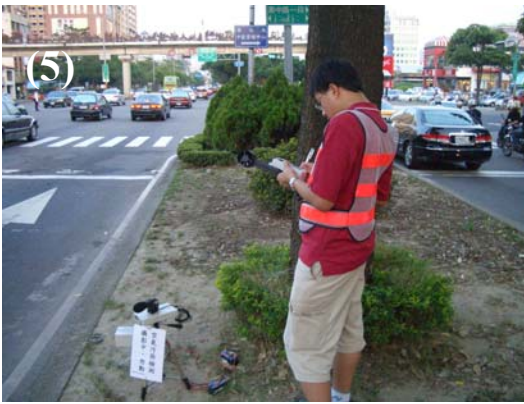
圖 7 實測步驟。(1).檢查儀器與裝入記憶體，(2).裝設攝影機並設定啓始時間，(3).安裝監測器，(4).電腦設定數據擷取器參數，(5).記錄各項操作條件，(6).完成準備工作開始自動監測。
