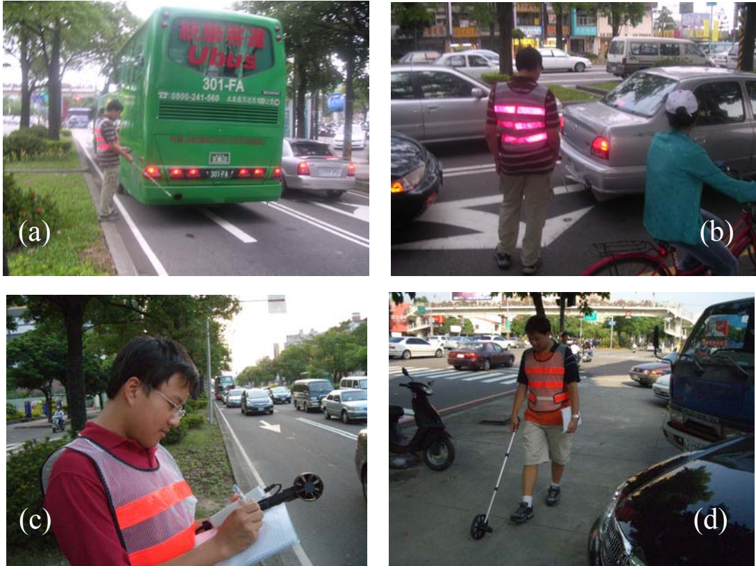
圖 7 輔助實測工作。(a).大型汽車(巴士)排氣溫度量測，(b).小型汽車(轎車)排氣溫度量測，(c).環境風速量測(每次實測時)，與(d).實驗路段長度量測。
