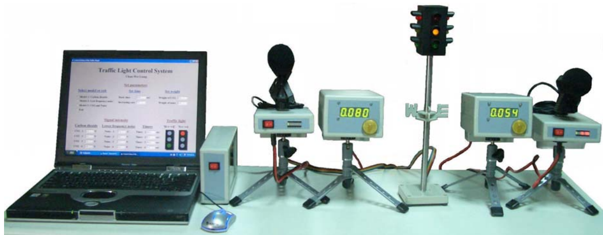
圖 19. 組合電腦、制系統硬體與二組 CO 2 與低頻噪音監測器照片，其中一組代表東-西向(E↔W)車道監測設備，另一組代表南-北向(S↔W)車道之監測設備。
