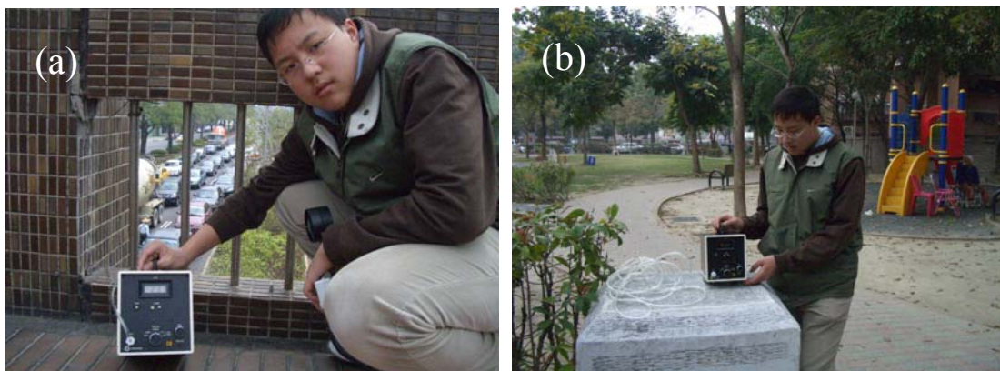
圖 3. 以 CO 監測儀(Interscan Co. Model No. 1148DG, CO Analyzer)進行初步道路與背景測試。(a).於天橋上接採樣管偵測，(b).於寧靜公園內偵測。
