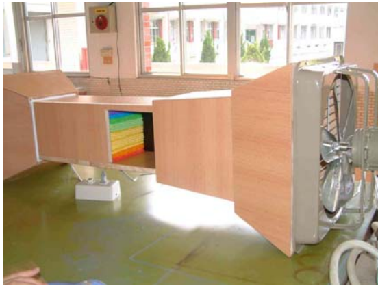
圖十三 自製之風洞裝置
