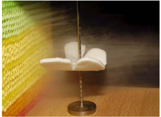
圖十九 觀察蝴蝶模型之氣流方向及升力情形
