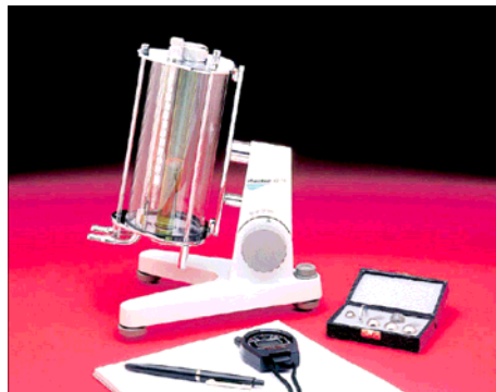
圖三、市面上販賣的落球式黏度測定器
