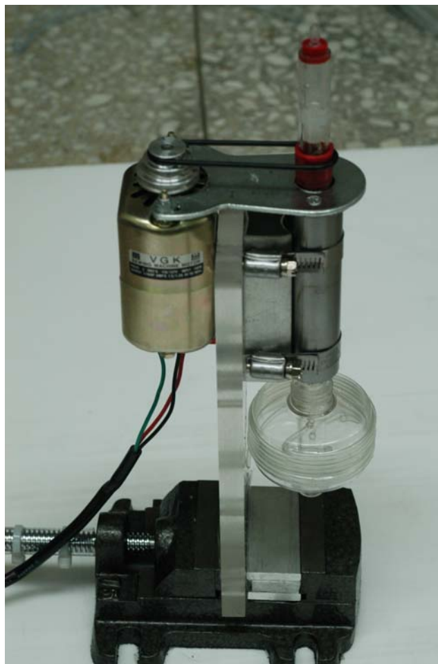
照片 9 連續篩選式離心機(Picture 9 連續式離心式篩選機)
