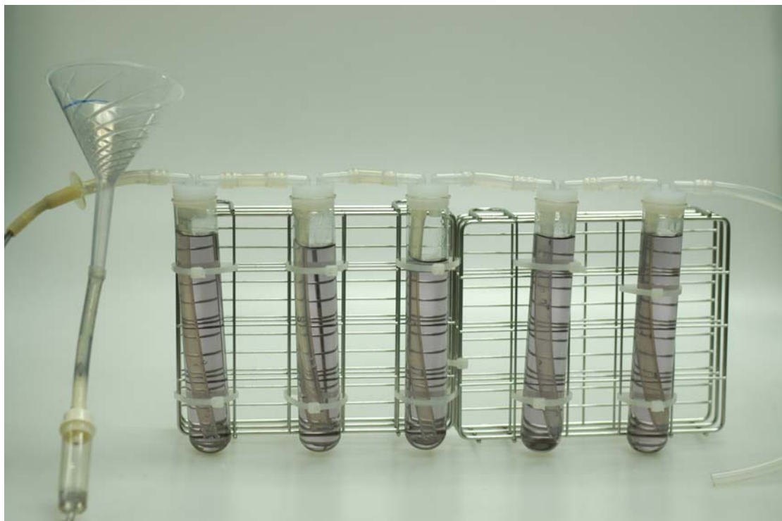
照片 7 沉澱過濾器 (Picture 7 沉降過濾器)
