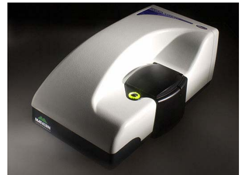
Nano ZetaSizer，本研究測量界達電位與粒徑大小之儀器。 8
