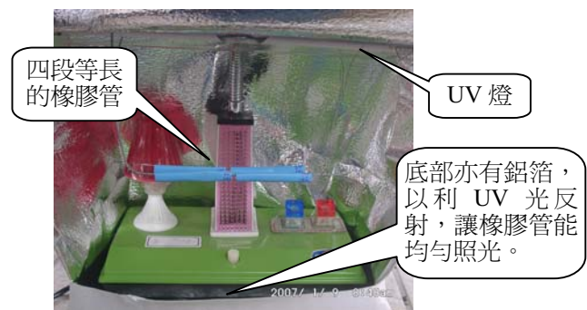
紫外光燈裝置---內部構造
