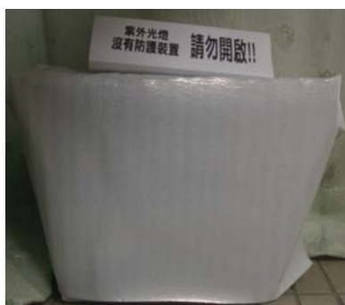
紫外光燈裝置外觀(外部罩以內襯鋁箔的隔熱紙，以防紫外光外洩)
