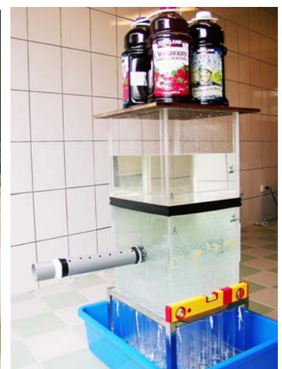
圖 c-11 實驗組(隧道剛挖) --給水後
