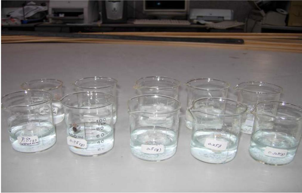
圖四：TiO<sub>2</sub> 還原硫酸銅 0.01M，照射紫外光 24 小時後之變化，由照片可觀察到溶液表面並無紅色的銅金屬析出
