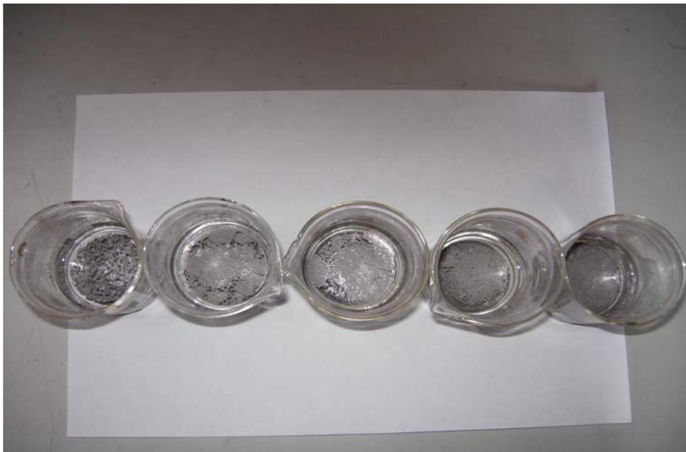
圖三：蒸餾水除氧處理後配製成  $\text{AgNO}_3$  (aq) 0.01M, 紫外光照射 24 小時,  $\text{TiO}_2$  還原銀金屬示意圖 (溶液表面生成大片銀金屬奈米微粒薄膜)
