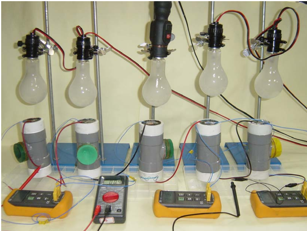
照片A：串聯 5個PVC管實用溫差電池
