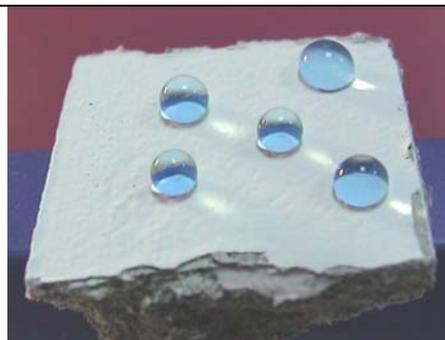
圖 3.8 亞甲基藍液在水泥板上之五個測試位置
