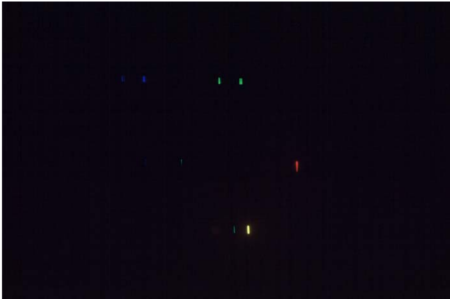
Pic.04 : Nikon FM2 相機 (100 度正片) 與 600 條/mm 光柵拍攝汞燈、氫燈、鈉燈光譜
