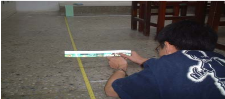
圖片 伍-3 將直尺固定在眼前 20 公分，使眼睛、尺的刻度和紙成一直線。再調整直尺和紙的距離，直到從眼睛透過尺看到紙只有實際大小的十分之一。
