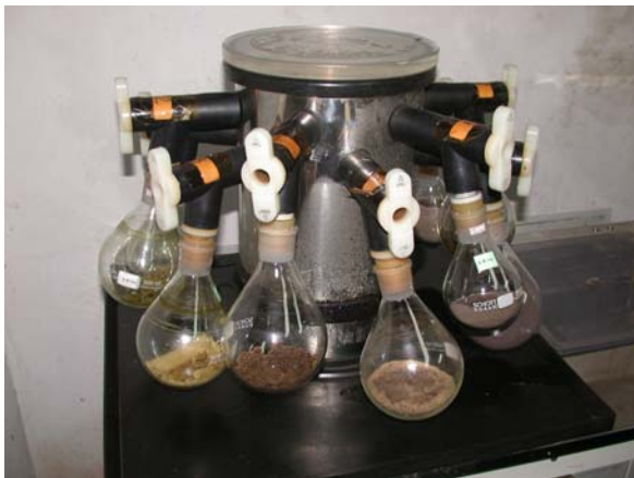
圖 2-2-13 冷凍乾縮 24hr 後之情形
