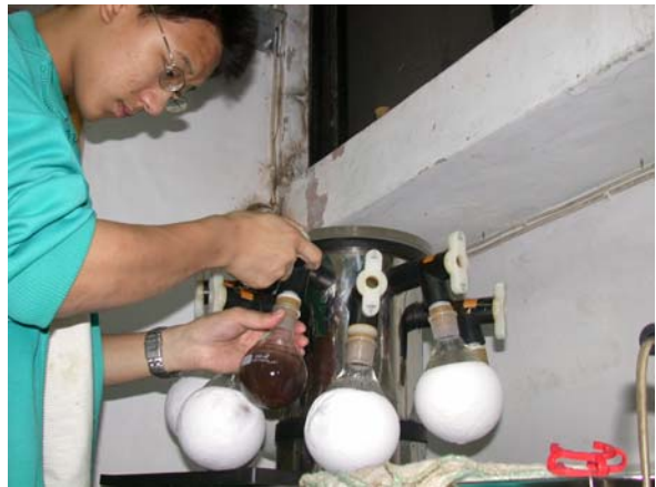
圖 2-2-12 接上冷凍乾縮機之操作過程
