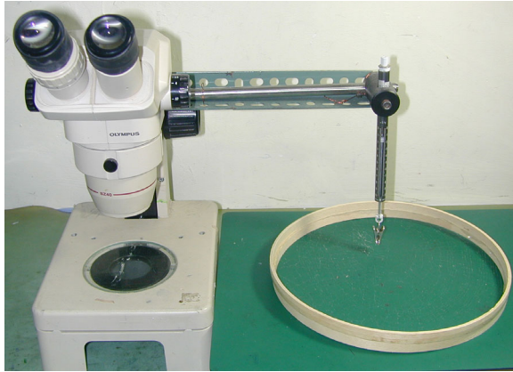
圖五(a)：顯微鏡轉軸帶動彈簧秤上下移動。
