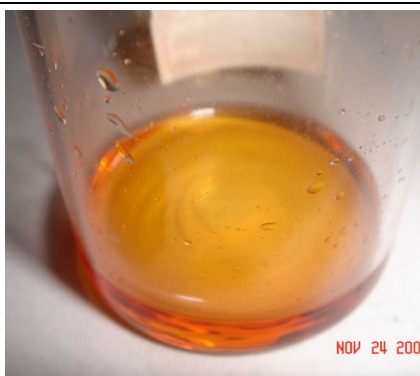
圖〈二十二〉以 m-Cresol 溶解耐綸-66
