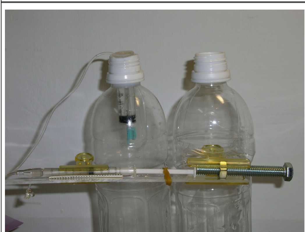
以螺絲為推進器，可更有效的控制油滴大小，使數據更為精確。
