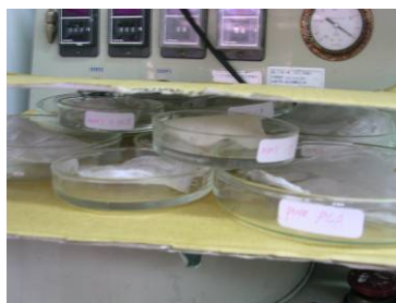
圖 i 溶液製備成膜 在通風櫥下乾燥
