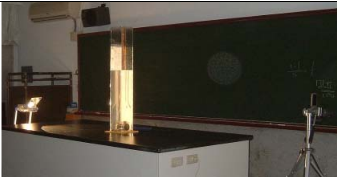
(c)實驗裝置-右起為投影機、實驗水槽（長 15cm、寬 15cm、高 1m）、數位攝影機 【圖一】
