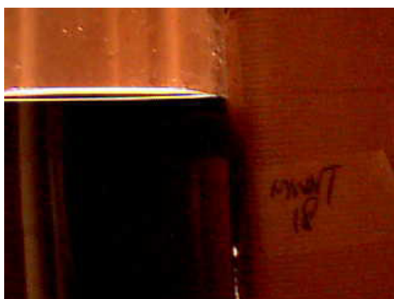
圖十四 經超音波震盪 18 小時後的多壁奈米碳管 此圖為從試管背後打光 顏色呈現茶色，目測可看出奈米碳管分布均勻。
