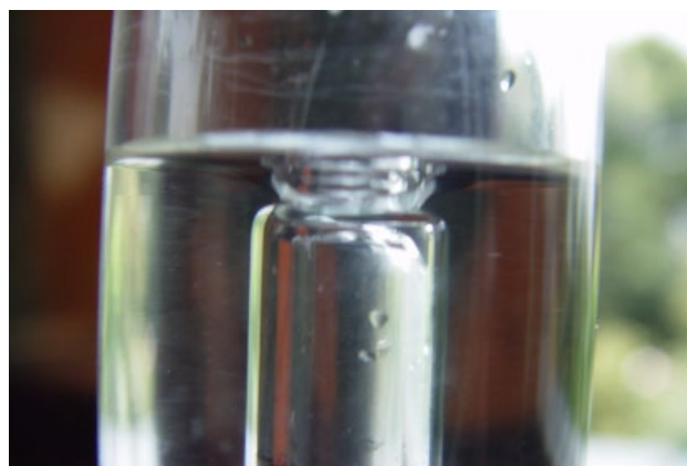
圖四-2 浮沈子恰要下沉，浮沉子在容器的正中央 (Cheerios effect 的相斥現象)
