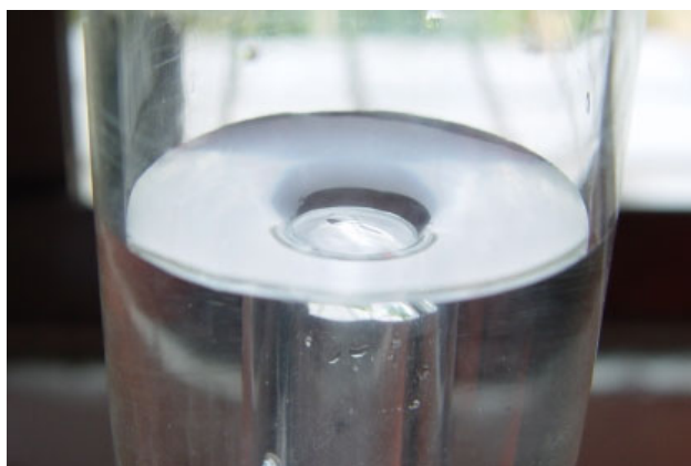
圖四-1 浮沈子快要下沉，浮沉子旁邊的水面呈凸透鏡式彎月形
