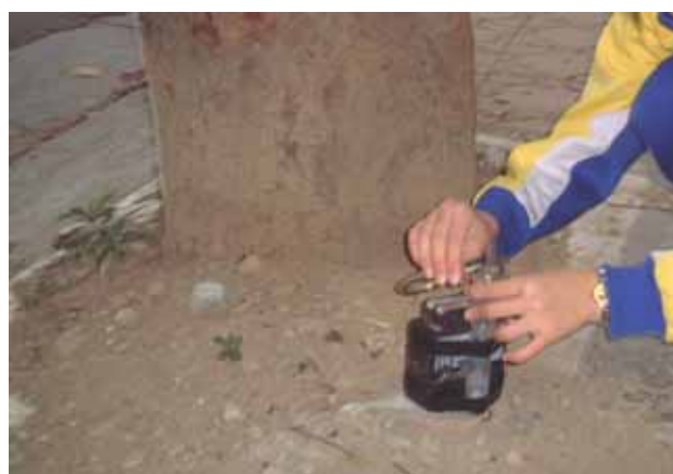
圖 29 以抽氣幫浦採取空氣樣品
