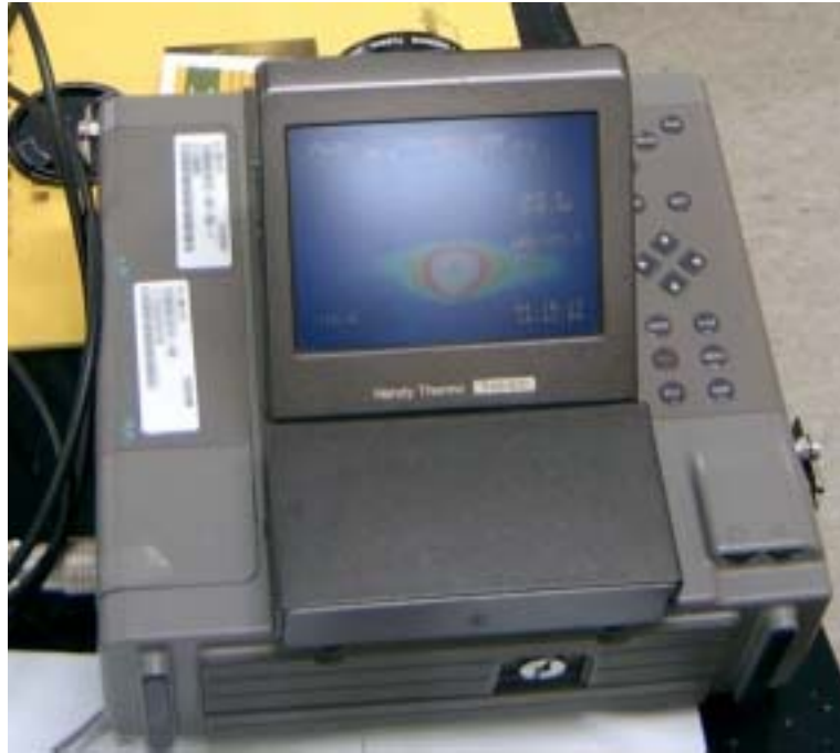
照片七、Avio TVS-100 紅外線熱影像儀。
