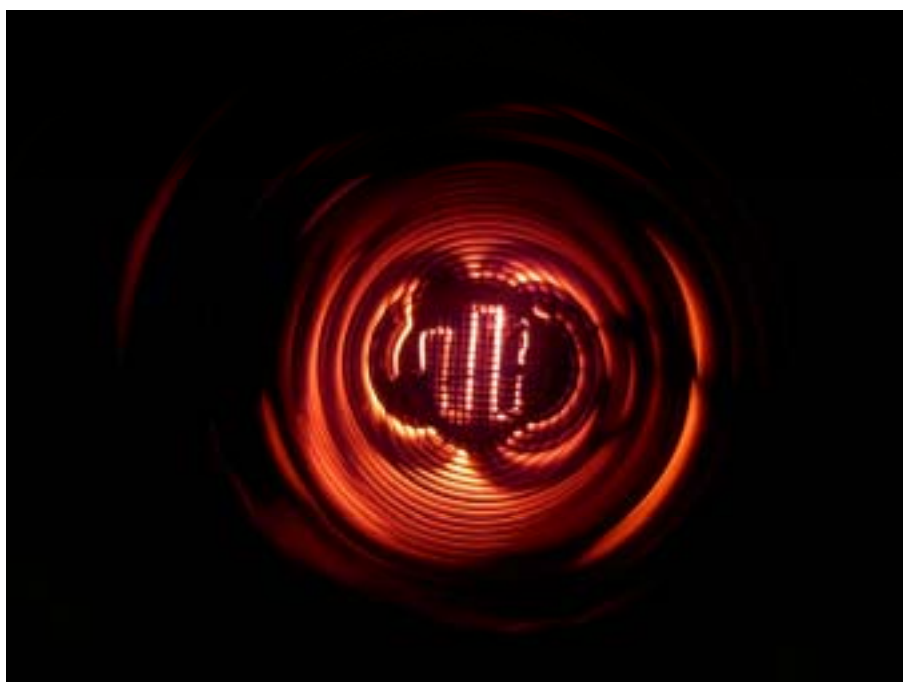
熱聲效應共振管中加熱中的鎳鉻絲。
