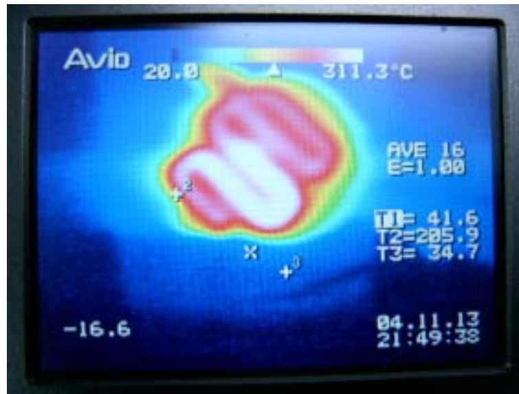
照片十、降低輸入電流時，片堆的溫度才降到觀測範圍內。 其中蛇狀纏繞的是鎳鉻電阻。
